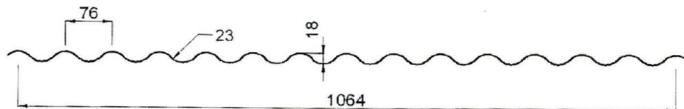
Abbildung 3: Querschnitt des Stahl-Wellprofils W1/1064 (18/76)
